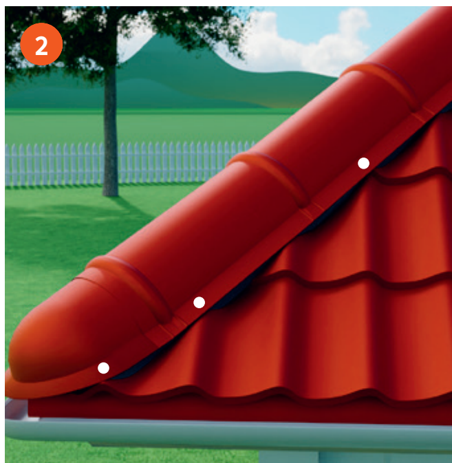
Placera en nockplåt och en valmavslutning längst ner och fäst de båda i profiltopparna på takpannorna med överlappsskruv.
