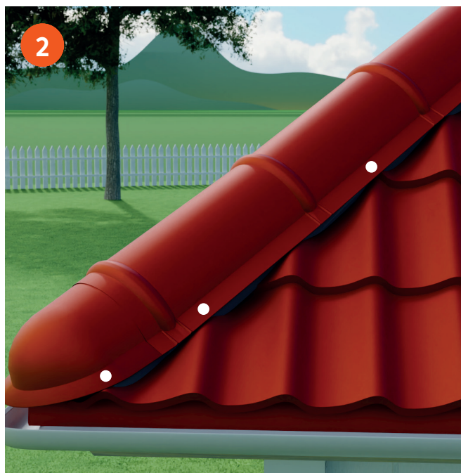
Placera en nockplåt och en valmavslutning längst ner och fäst de båda i profiltopparna på takpannorna med överlappsskruv.
